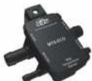
**8.4 REDUTOR DE PRESSÃO POSITIVA:** reduz a pressão do GNV de 200 bar para 1 a 1,25 bar de saída, ou (100 a 250 kpa). É projetado para sistemas de injeção sequencial, para manter uma pressão constante com diferentes fluxos requeridos pelo motor. Na maioria dos equipamentos existentes no mercado nacional é necessário ligar as entradas de água quente para a condição ideal de trabalho e garantir um fluxo de gás correto para todas as exigências do motor.
